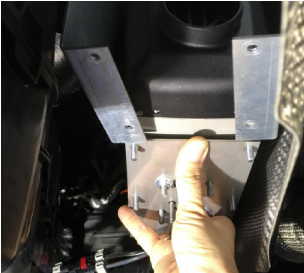
L'utilisation de Loctite 242 est recommandée pour les filetages.
